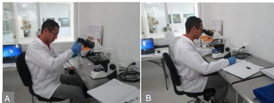
Fotografía 5-11. A) Montaje de la muestra de fitoperifiton por el método de Lackey, B) Identificación y conteo de las microalgas en el microscopio binocular.
