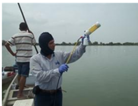
Fotografía 5-3. Transvaso y fijación del fitoplancton
