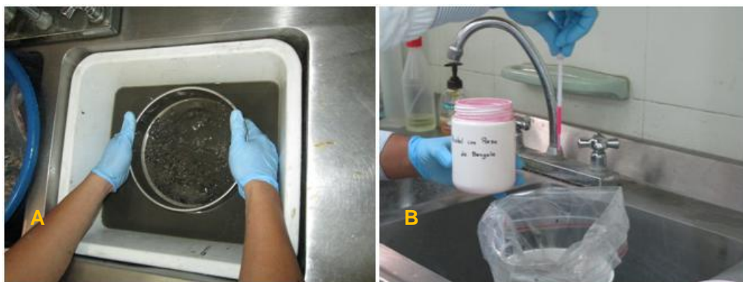
Fotografía 5-14. A) Lavado de las muestras en el laboratorio y B) coloreado de las muestras con rosa de bengala
