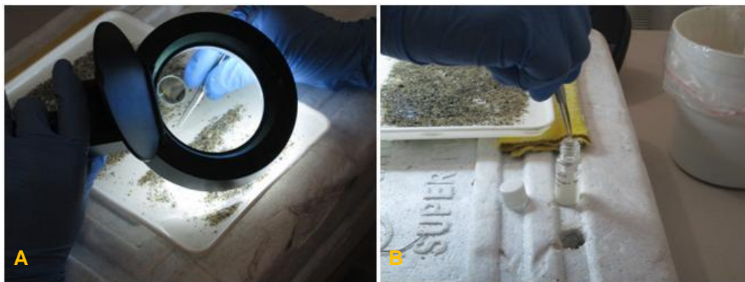
Fotografía 5-15. A) Separación de los organismos del sedimento y B) almacenaje en viales
