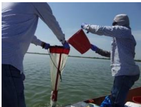
Fotografía 5-5. Filtrado de volumen conocido en la malla de zooplancton
