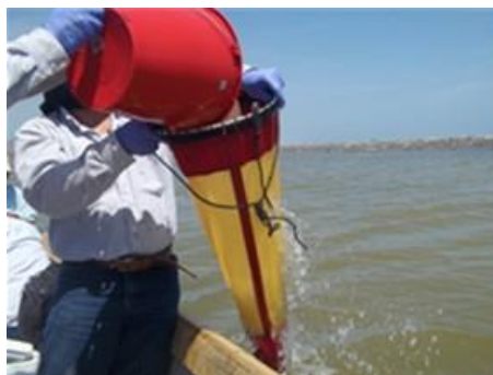
Fotografía 5-2. Filtrado de volumen conocido en la malla de fitoplancton
